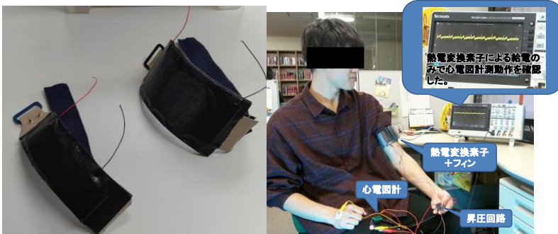
図 2 試作デバイス (左) と心電図実測評価の様子 (右)
