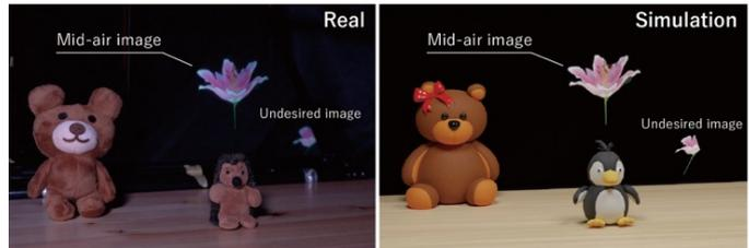
図 1 物理ベースレイトレーシングによる空中像再現(左) 実際の空中像(右)シミュレーションによる再現
