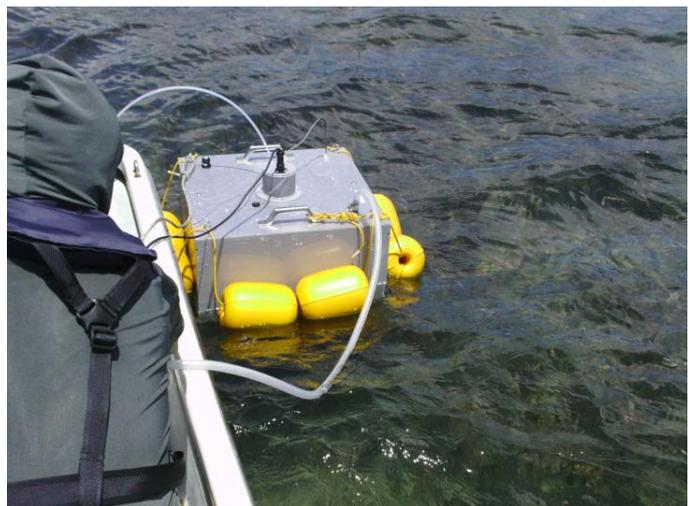
図2 大気と海水の間の  $\text{CO}_2$  吸収・放出（フラックス）を観測する装置。上：渦相関システム（大気中  $\text{CO}_2$  濃度と鉛直風速の変動成分を連続観測する手法）、下：チャンバーシステム（チャンバー内に閉じ込められた大気中の  $\text{CO}_2$  濃度の経時変化を観測する手法）
