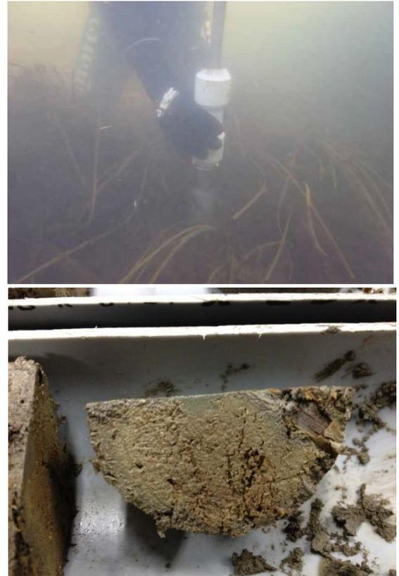
図6 上:堆積物コアの採取状況, 下:採取された堆積物コア断面の様子.
